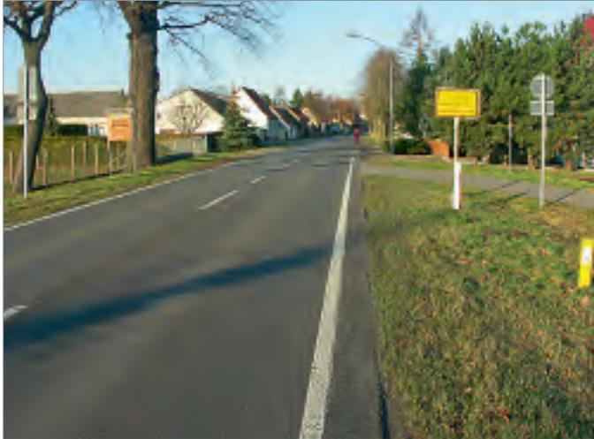
Bild 4: Ortseingang ohne geschwindigkeitsdämpfende Maßnahmen und unsicherer Führung des Radverkehrs
