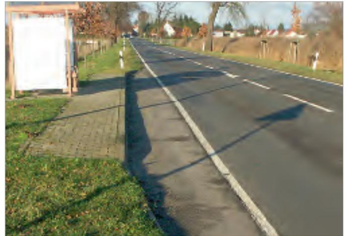
Bild 8: Bushaltestelle im Außerortsbereich ohne Gehweganbindung – ungesicherte Führung der Fußgänger
