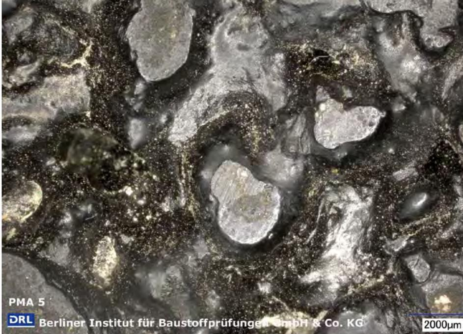
Abb. 11: PMA-Oberfläche mit Laser-Scanning-Mikroskop
