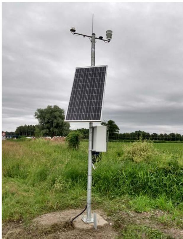
Bild 6: Messstation zur Messung der Betontemperaturen, der Fugenbewegungen und der Klimadaten
