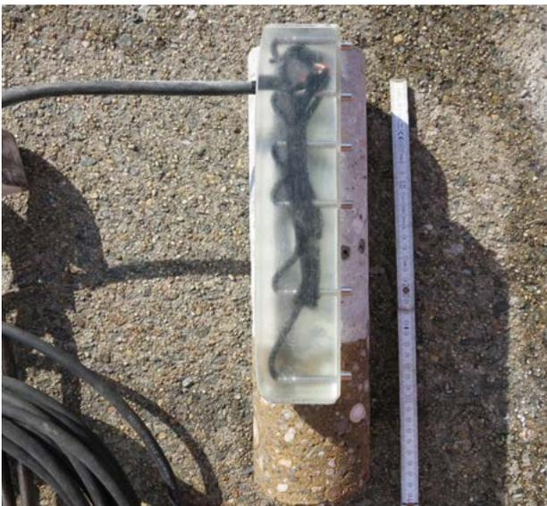
Bild 4: Temperaturmessfühler zur Messung in sechs Ebenen
