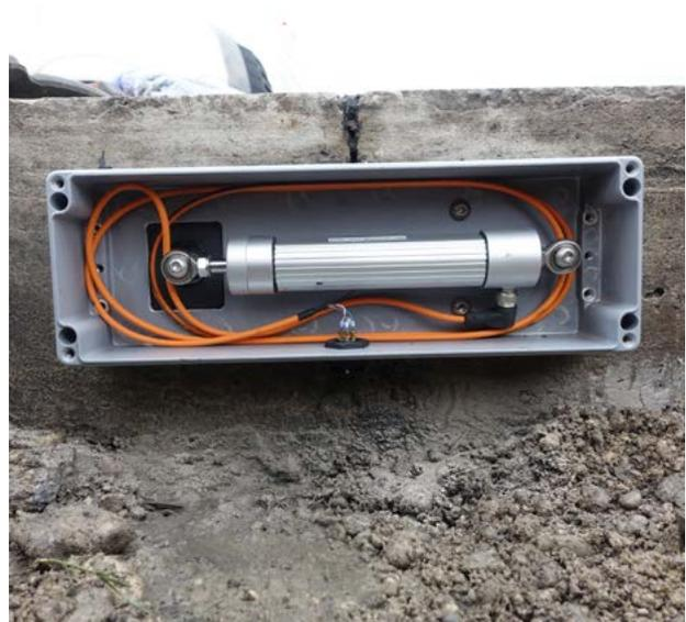
Bild 5: Messsystem zur Ermittlung der Fugenbewegungen
